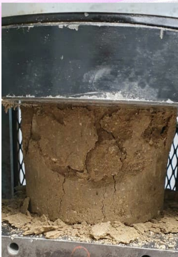
Prøveemne efter uniaxialt trykforsøg.
