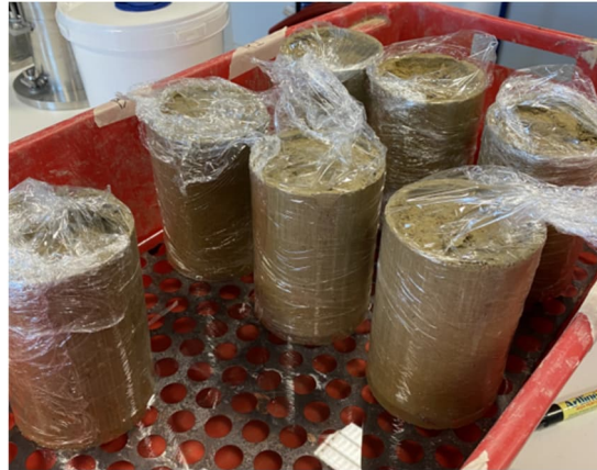
Figur 3.2: Eksempel på forsøgsopstilling til bestemmelse af kapillær stighøjde (foto fra AAU).
