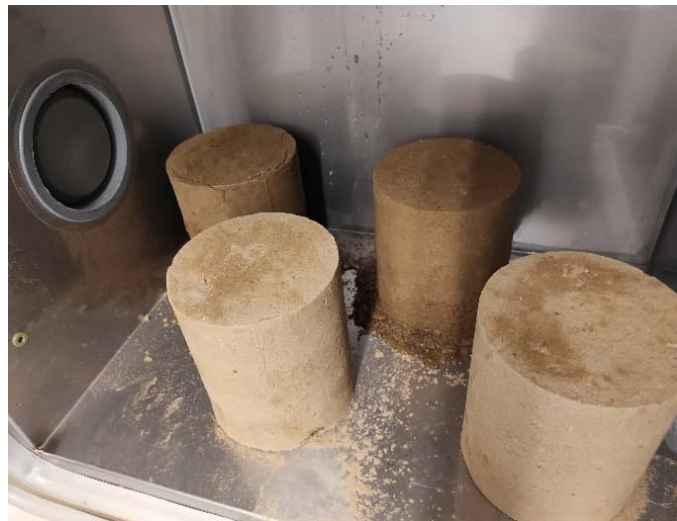
Figur 3.9: Prøveemner delvis udtørret efter frost/tø påvirkning.
